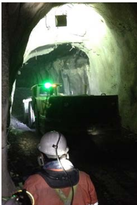
Дистанционное управление подземным погрузчиком в пределах прямой видимости
