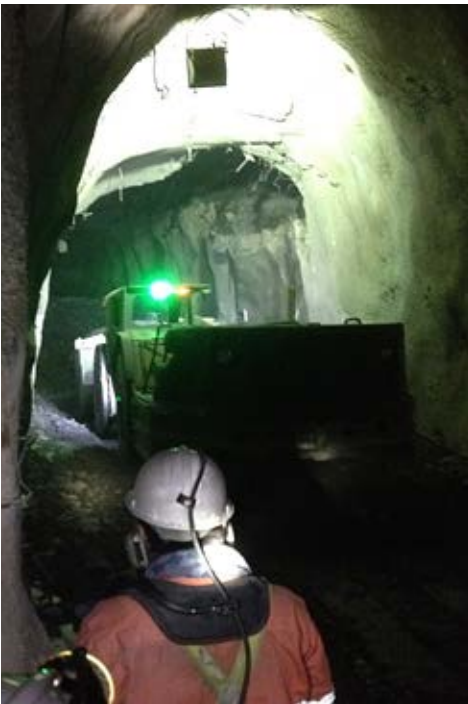
Control Remoto vía Line-of-Sight en cargadores en faenas subterráneas
