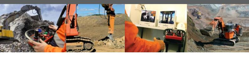
ЭКСКАВАТОРЫ И КАМНЕДРОБИЛКИ ЗАЧАСТУЮ ИСПОЛЬЗУЮТСЯ ДЛЯ РАБОТЫ В ОПАСНЫХ УСЛОВИЯХ. ДЛЯ ГАРАНТИИ БЕЗОПАСНОСТИ ОПЕРАТОРОВ НЕОБХОДИМО ПЕРЕМЕСТИТЬ ИХ ИЗ ЗОНЫ ВЫСОКОГО РИСКА В МАШИНЕ И ОБЕСПЕЧИТЬ ЭФФЕКТИВНУЮ РАБОТУ ИЗ БЕЗОПАСНОГО МЕСТА НА РАССТОЯНИИ ОТ ОПАСНОЙ ЗОНЫ.
