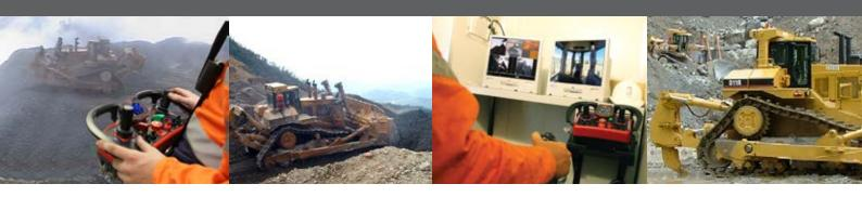
DOZERS ARE OFTEN REQUIRED TO OPERATE IN UNSTABLE OR HIGH RISK ENVIRONMENTS. IN ORDER TO ENSURE THE SAFETY OF DOZER OPERATORS, IT IS NECESSARY TO REMOVE THEM FROM THE HIGH RISK AREA AT THE MACHINE AND ENABLE EFFICIENT OPERATION FROM A SAFE LOCATION SOME DISTANCE AWAY.
